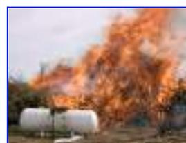
Pour l'ensemble des scénarii, les résultats obtenus, d'abord après l'analyse théorique, puis également, pour les deux derniers cas, des essais expérimentaux, ont permis d'écarter le scénario de BLEVE.
