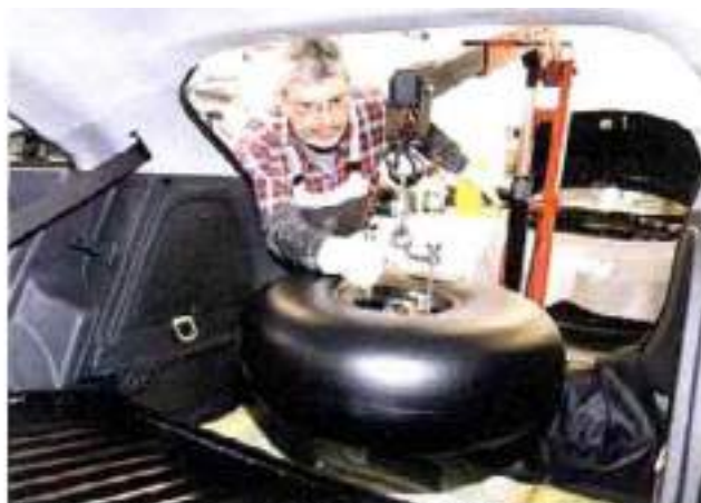
Montage d'un réservoir de gaz dans une usine Opel. Le constructeur allemand croit toujours au GPL. (G. COMTE)
