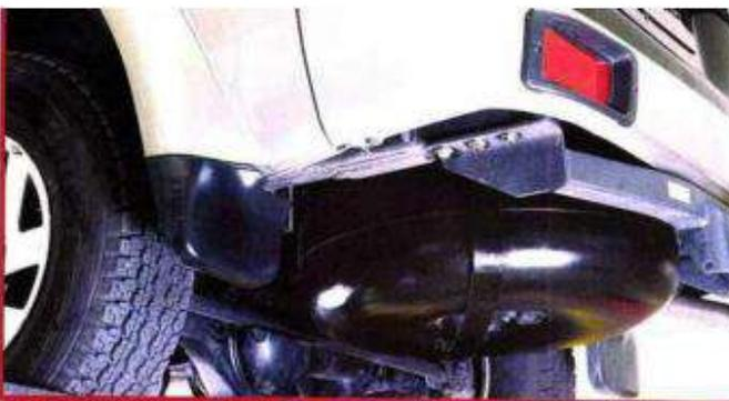
■ Un réservoir technique GPL, protégé le plus possible de la roue de secours.
