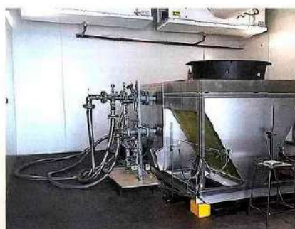
Prototypé testé dans l'enceinte climatique négative du Pôle Cristal : il s'agit du modèle de plus petite puissance à un seul circuit et hélicoïde (doc. ETT).
