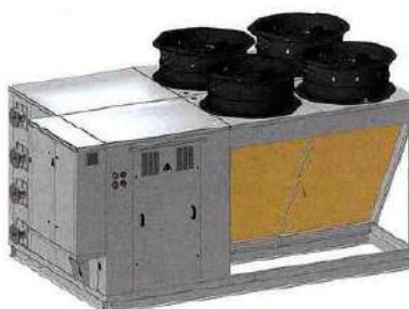
Image de synthèse du châssis des modèles Ecops 160-210-270, avec 2 circuits et 4 hélicoïdes : le compartiment technique est équipé d'un détecteur de fuite, le tableau électrique IP54 est séparé (doc. ETT).
