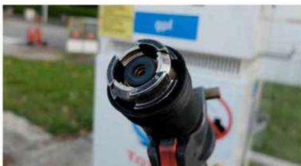
Le traditionnel pistolet est remplacé par une baïonnette hermétique dont le maniement est très vite assimilé. Photo P.L.
